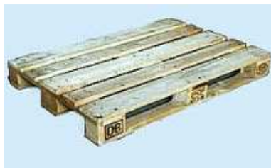
Европоддон (европаллет, европул) по ГОСТ 9557-87. Размеры: 144x800x1200 мм, грузоподъемность 2500 кг
