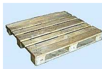
Поддон стандарта DIN по ГОСТ 9078-84. Размеры: 144x1200x1000 мм, грузоподъемность 2000 кг.
