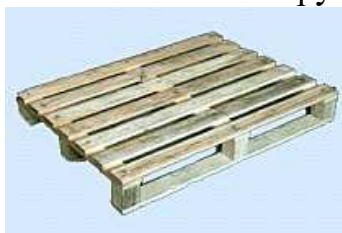
Поддон плоский одноразовый по ГОСТ 26381-84. Размеры: 145x1000x1200 мм, грузоподъемность 1500 кг. Поддон предназначен для однократного применения.
