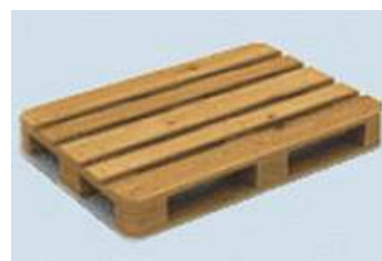
Европоддон по ГОСТ 9078-84. Размеры: 144x800x1200 мм, грузоподъемность 2500 кг
