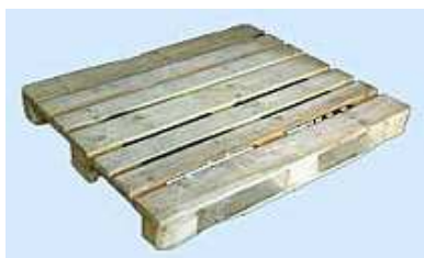
Поддон стандарта FIN по ГОСТ 9078-84. Размеры: 145x1000x1200 мм, грузоподъемность 1500 кг.
