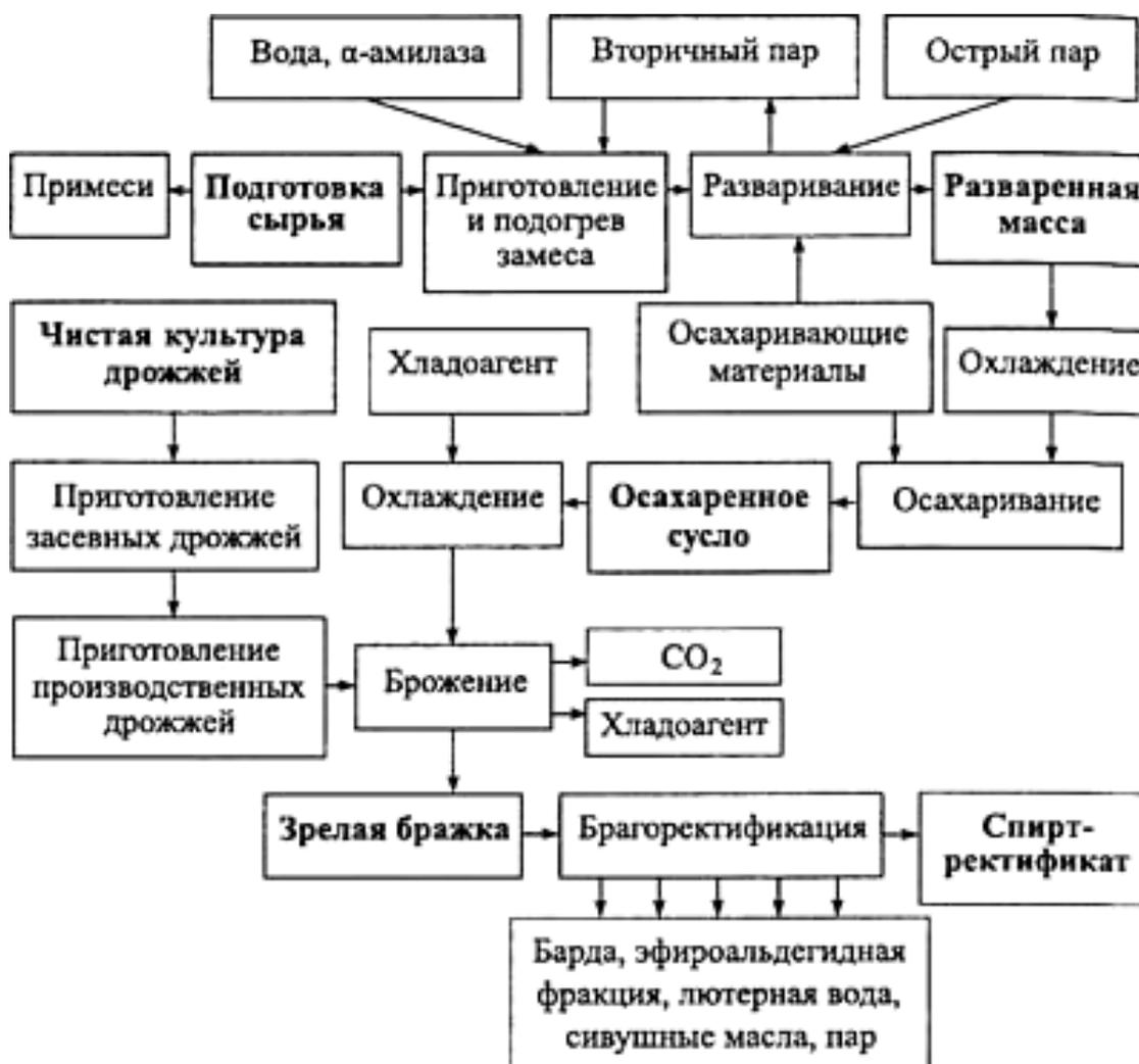
Рис. 2. Технологическая схема производства этилового спирта из зерна и картофеля
